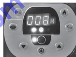
Después que el ciclo se haya completado, la pantalla LED mostrará la temperatura del agua. Hacer una comprobación con las tiras de prueba y asegurarse que el nivel de cloro se sitúa entre 2 y 4 ppm.
